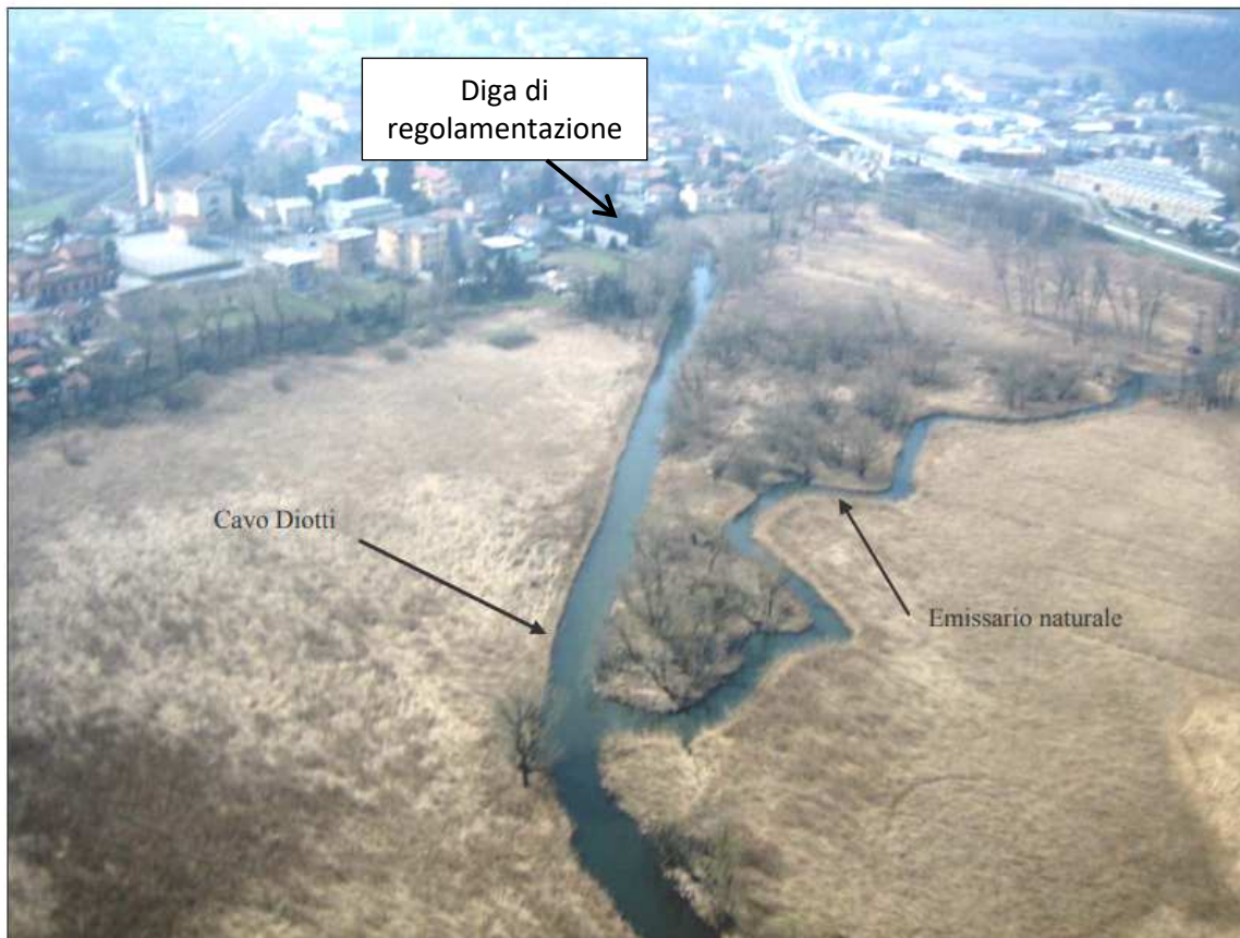
Figura 7.2 – Vista dal lago della diramazione Cavo Diotti-Lambro, a valle del Lago di Pusiano: si nota il corso naturale del Lambro (a destra nella foto) ed il Cavo Diotti (realizzato all’inizio dell’ottocento per lo sfruttamento industriale della risorsa idrica).
